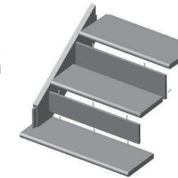
3. На основание крепят первую ступень 940x320 мм (поз. 11) с подступенью 900x160 мм (поз. 12). К ней и двум ближайшим столбам в пазы устанавливают две нижних струны 1000x250 мм (поз. 13).
