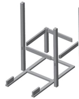
2. К связкам прикрепляют четыре столба (720 мм(поз. 4), 2050 мм (поз. 3) и два 1760 мм (поз. 5 и 6)). Между собой столбы стягивают четырьмя планками 790 мм (поз. 7), которые ставятся в пазы. Все вместе скрепляется саморезами 3,5x70 мм
