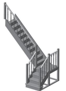
10. После установки и осадки лестницы весь крепеж затягивают окончательно.
