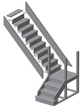
7. Между струнами с помощью металлических уголков закрепляют десять ступеней 800x220 мм (поз. 22 и 23) с подступенями 780x160 мм (поз. 21) и 800x200 мм (поз. 24). Фиксируется все саморезами 3,5x35 мм.
